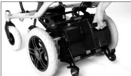
23. ábra Az akkuegység kivétele
