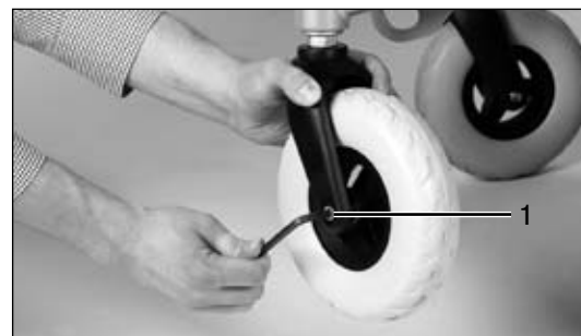
32. ábra Az első kerék leszerelése
