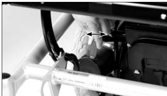
21. ábra A fék kioldása
