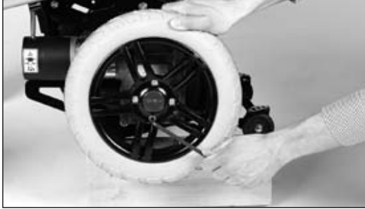
Şek. 31 Tahrikli tekerleğin sökülmesi
