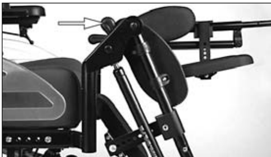
27. ábra Mechanikusan felfelé félrehajtható lábtartó
