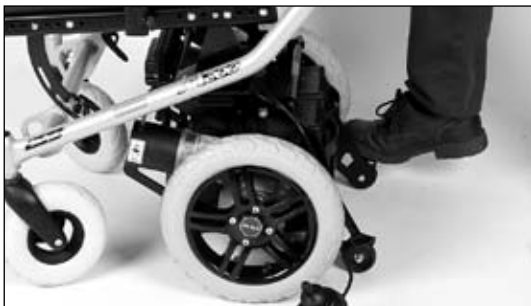
7. ábra A billenéságtató lenyomva
