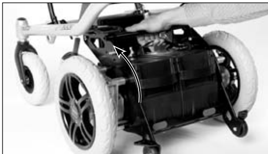
10. ábra Az akkuegység biztosítása
