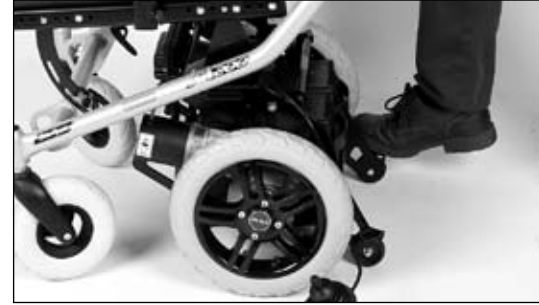
Şek. 7 Aşağıya doğru bastırılmış devrilme koruması
