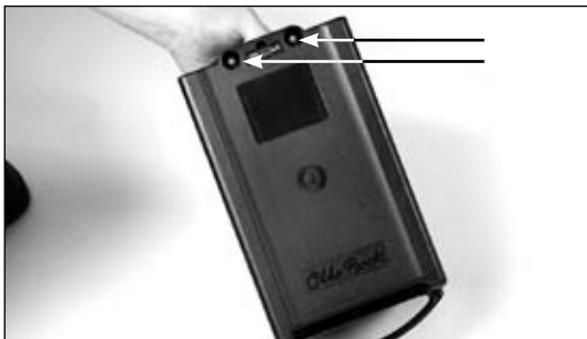
24. ábra Az akkuegység alulnézetben
