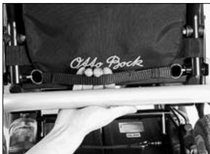
12. ábra A háttámla zárkioldó hevedere
