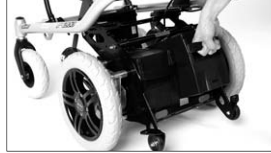
Şek. 23 Akü paketinin çıkarılması
