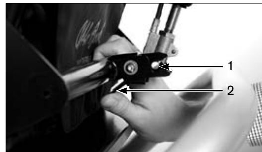
26. ábra A rögzítőbe záródó csapszeg
