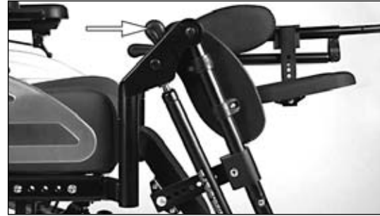
Şek. 27 Mekanik yukarı kaldırılabilir ayak desteği
