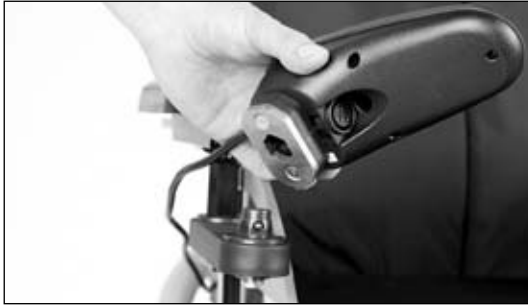
Şek. 14 Dışarı döndürülebilir kumanda paneli tutucusunun çekilmesi
