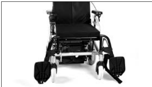
19. ábra Oldalra fordított lábtartók
