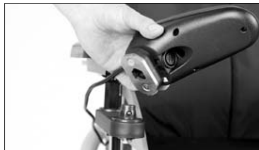
14. ábra A félrefordítható kezelőpult-tartó lehúzása
