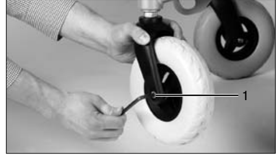
Şek. 32 Ön tekerleğin sökülmesi
