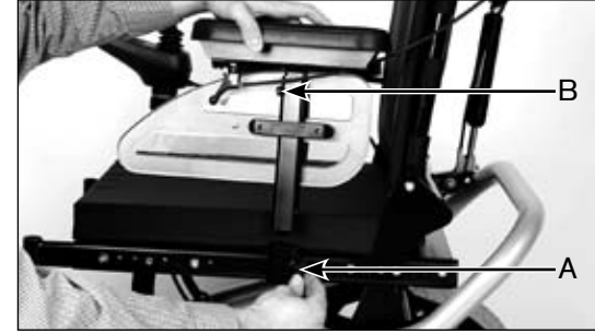
Şek. 13 Yan parçanın çıkarılması
