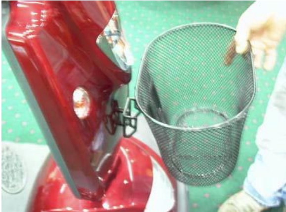
Első kosár telepítése
