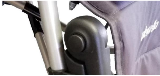
35.ábra lábtartó beállító szerkezet
