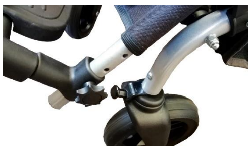
24. ábra Lábtartó hossz beállító csavar.
