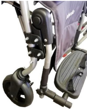
35.ábra lábtartó beállító szerkezet
