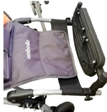
37. ábra lábtartó beállító szerkezet
